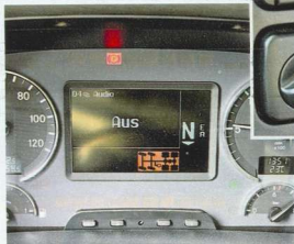
Пиктограмма на дисплее показывает состояние дифференциалов трансмиссии – их блокировками управляет удобный вращающийся переключатель. Рядом – переключатель раздаточной коробки.
