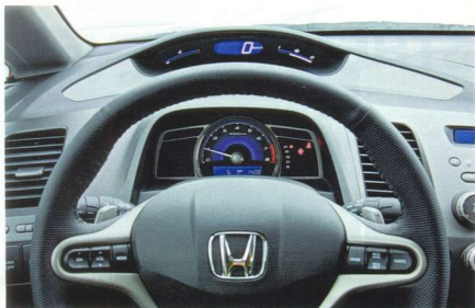
❗ Двухъярусное оформление электронных приборов усложняет одновременное считывание показаний спидометра и тахометра.
